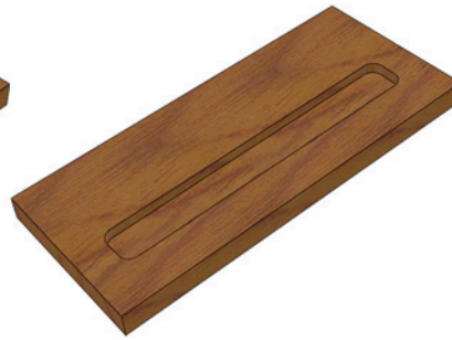
Mit einem 20er-Werkzeug und Nachbearbeitungsradius von 2 mm
